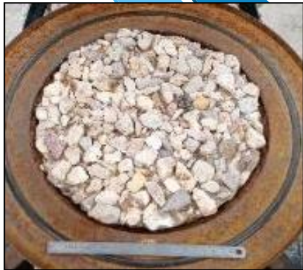
Essai de Poinçonnement hydrostatique Prova di punzonatura idrostatica
