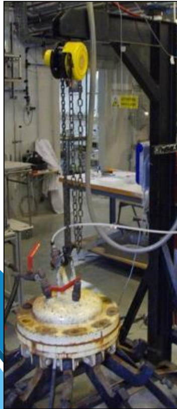
Essai de Poinçonnement hydrostatique Prova di punzonatura idrostatica
