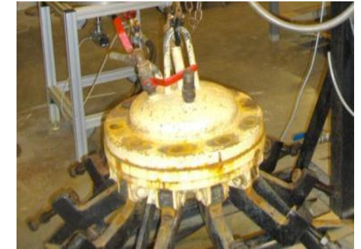
Application de la pression hydraulique (4 jours) Applicazione della pressione idraulica (4 giorni)
