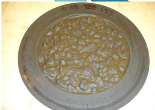
Géomembrane endommagée Geomembrana danneggiata
