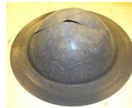
Comparaison résistance avec géomembrane vierge Confronto di resistenza con geomembrana vergineo
