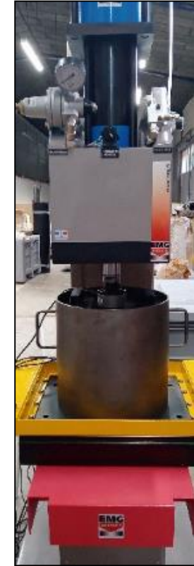
Essai de Poinçonnement géostatique Prova di punzonatura geostatica
