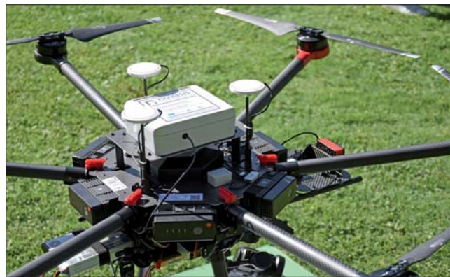
4. Dispositivo di acquisizione dati climatico-ambientali posizionato sul drone. (LAS)
