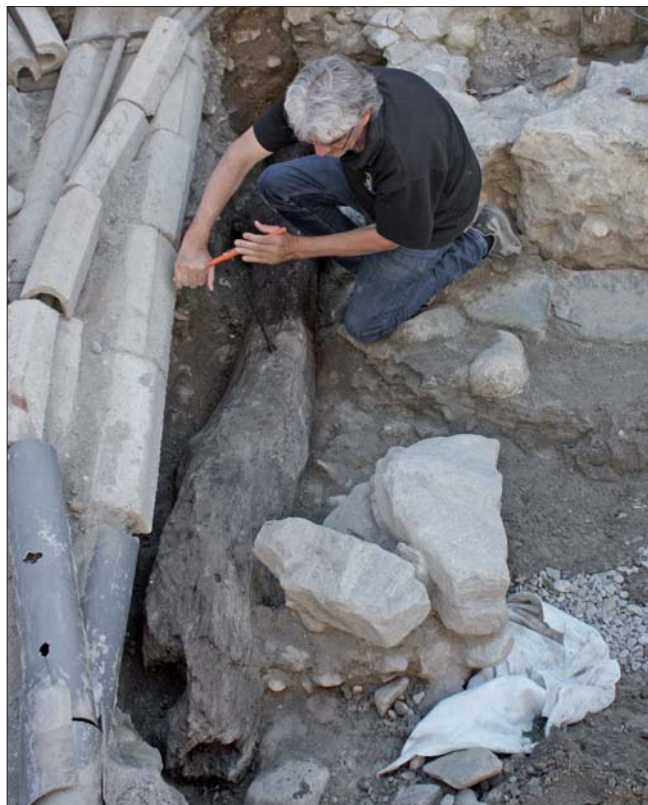
19. Le operazioni di carotaggio della trave in castagno per l'analisi al radiocarbonio. (G. Sartorio)
