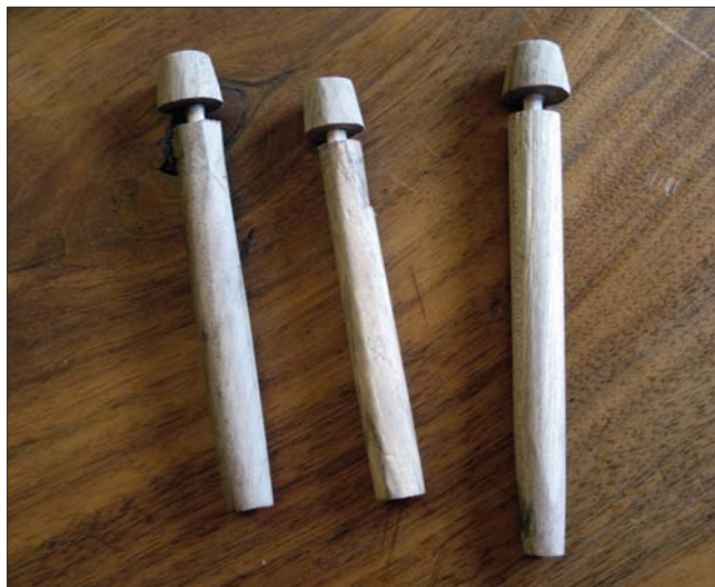
13. I perni lignei realizzati in sostituzione degli antichi chiodi perduti. (C. Béthaz)
