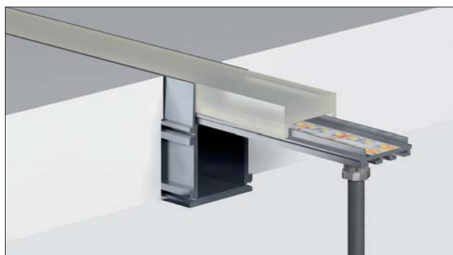
4. Schema con profilo in alluminio dell'incasso lineare per la lampada Flatlight 240 PG 27 K. (FibreTec S.r.l.)
