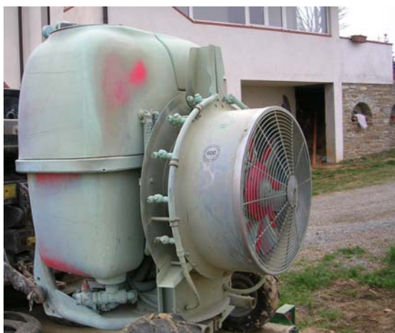
Figura 15: Esempio della contaminazione esterna di un'irroratrice per colture arboree.
