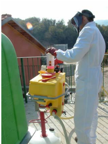
Figura 60: Pre-miscelatore di tipo indipendente, alimentato dalla rete idrica aziendale.
