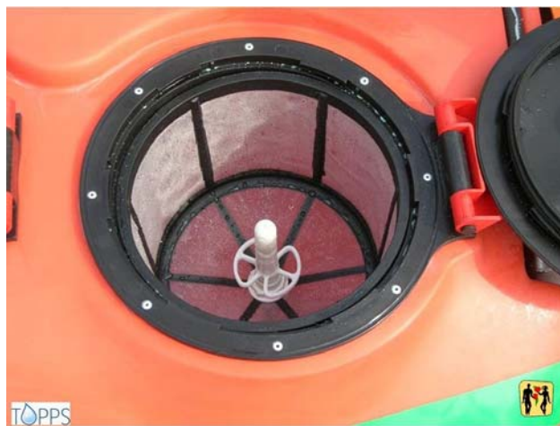
Figura 56: Ugello lava barattolo montato all'interno del filtro a cestello presente nell'apertura principale del serbatoio dell'irroratrice.
