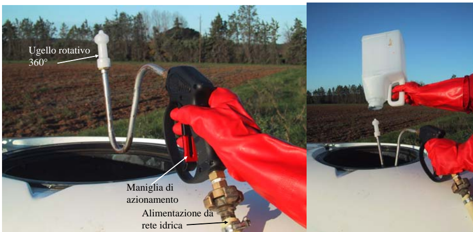
Figura 58: Ugello lava barattolo di tipo indipendente, collegabile direttamente alla rete idrica aziendale (modello Rinçotop®, raccomandato da Syngenta®). Foto: Syngenta.
