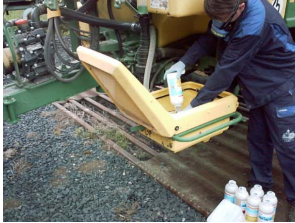
Figura 57: Esempio di utilizzo del dispositivo per il lavaggio dei contenitori di agrofarmaci montato all'interno del serbatoio pre-miscelatore.
