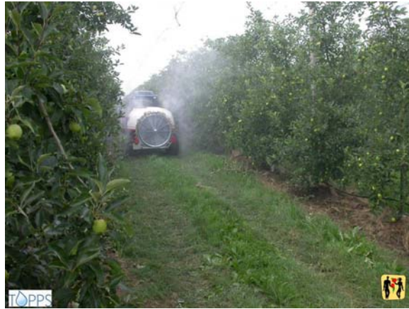
Figura 4: Esempio di deriva generata nella fase di distribuzione della miscela fitoiatrica in un frutteto.
