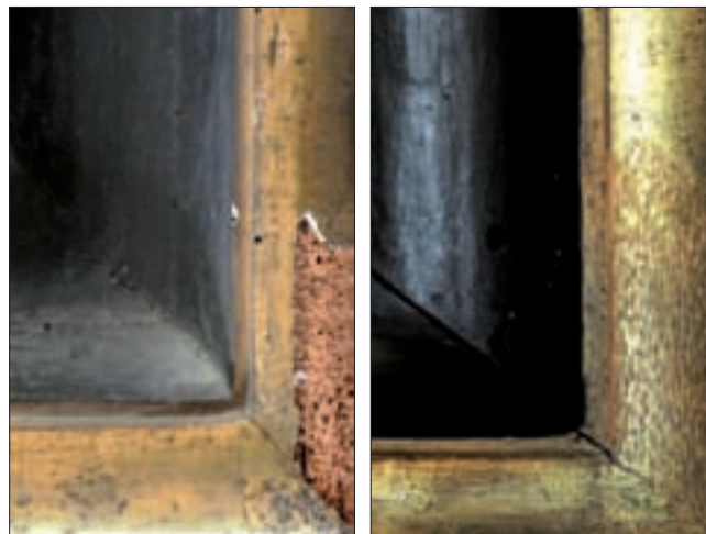
16a.-b. Stazione VI: a) degrado del supporto ligneo; b) stesso dettaglio dopo l'integrazione. (Studio di Restauro Malachite)
