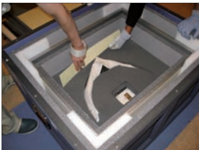
5. Data logger all'interno della cassa di trasporto. (L. Berriat)
