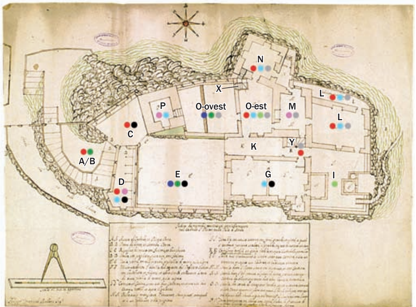
9. Pianta del castello di Saint-Pierre redatta dall'ingegner Filippo Emanuele Bellano (1686) con indicazione degli interventi eseguiti tra XVI e XIX secolo. (G. Sartorio)
