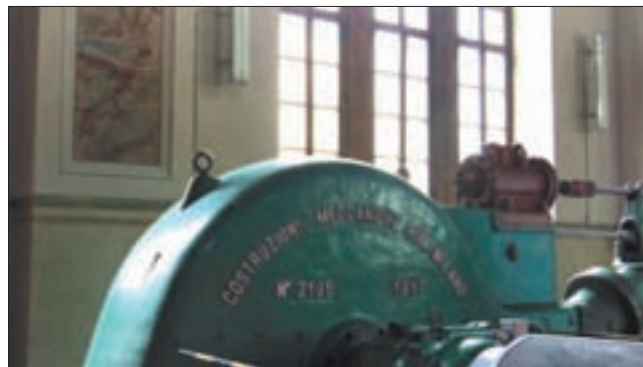
3. Turbina Pelton prodotta dalla Costruzioni Meccaniche Riva Milano, 1917. (C.F. Quiriconi)
