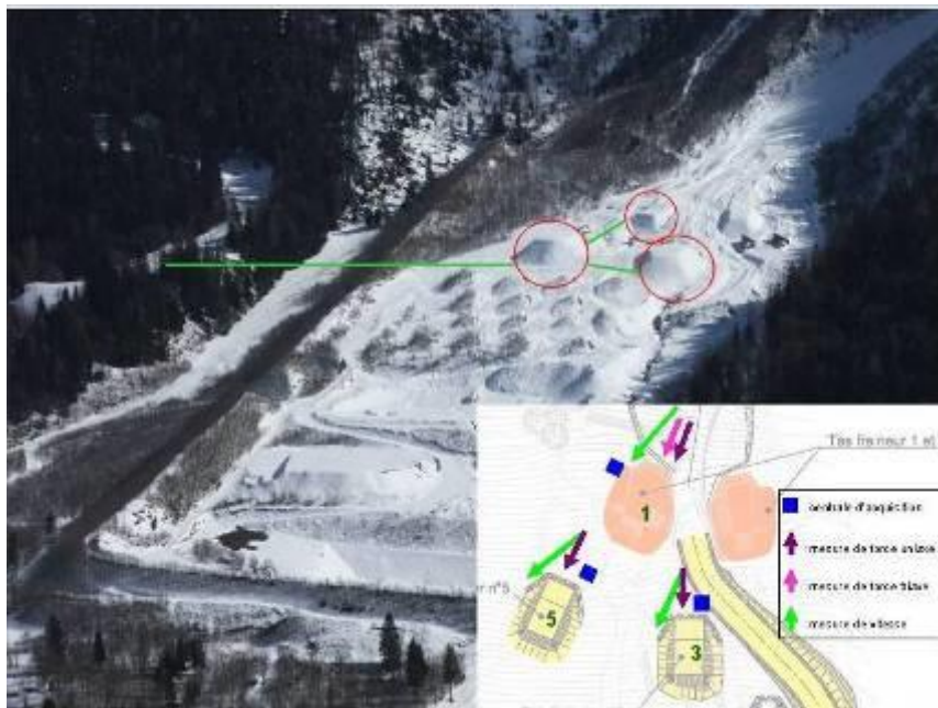
Couloir de Tacconnaz et dispositif expérimental
