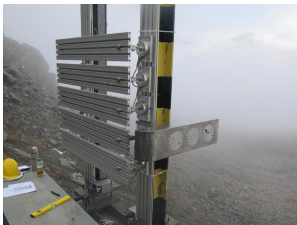
Obstacle avec les nouveaux capteurs de vitesse
