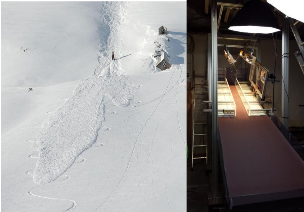
Vue de l'implantation du tripode où sont réalisées les mesures de vitesse et d'épaisseur de l'écoulement dans le couloir n°2 du Lautaret, à l'amont de la rupture de pente entre le couloir et la pente ouverte de la zone d'arrêt. A droite, l'abri hébergeant les systèmes d'acquisition et l'informatique. A droite une image du biplan.
