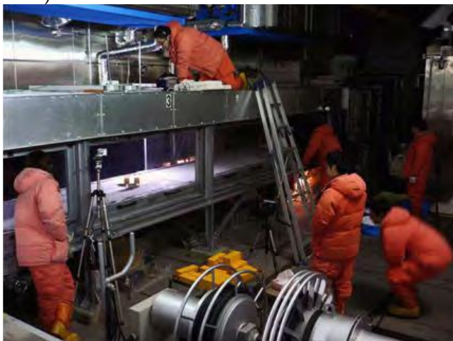
Soufflerie climatique du Cryospheric Environment Simulator Snow particle counter et anémomètre dans la soufflerie Simulator
