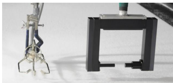
Soufflerie climatique du Cryospheric Environment Simulator Snow particle counter et anémomètre dans la soufflerie Simulator
