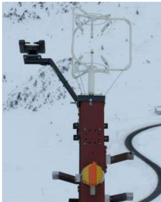
Anémomètre ultrasonique et Snow Particle Counter mis en place dans le couloir du Lautaret
