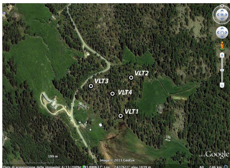
Géométrie de l'array infrasonique
