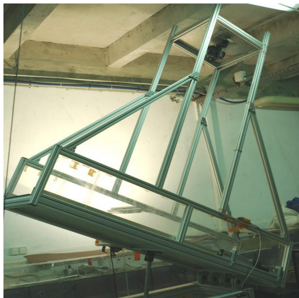
Canal inclinable utilisé pour les mesures des courbes h_{start}(\theta) et h_{stop}(\theta) . Le haut de la structure supporte l'appareil photographique utilisé pour imager la déviation de la ligne laser.
