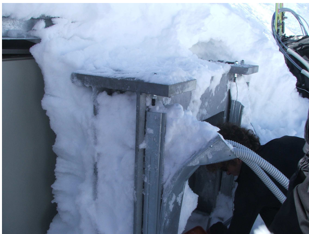
Les fondations et l'armoire électronique n'ont pas subi des dommages sérieux
