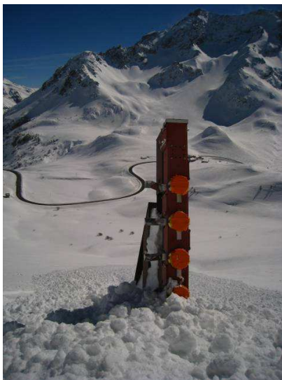
Mât de mesures avec capteurs de pression au couloir n° 2
