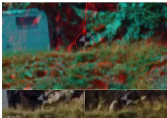
Position du pointeur sur une mire non utilisée. Le logiciel positionne le pointeur sur la position théorique (obtenue par GPS) à environ 10 cm de la position obtenue par orientation.
