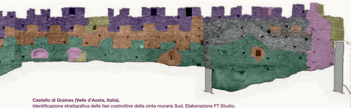
Château de Graines (Vallée d'Aoste, Italie). Identification stratigraphique des phases de construction de l'enceinte Sud. Doc. FT Studio.
