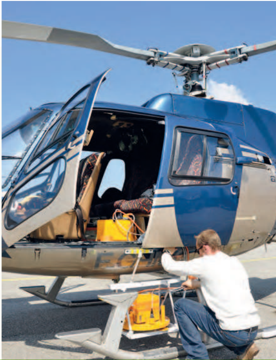
Predisposizione delle attrezzature per i rilievi fotogrammetrici. Foto L. D'Agostino – Hadès.
