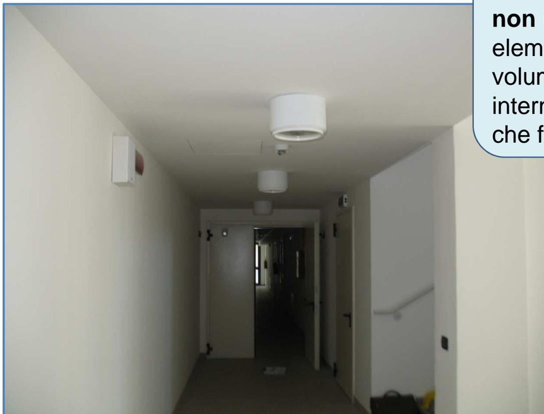
**Controsoffitto fisso e quindi non ispezionabile** (costituito da elementi fissi): per il calcolo del volume netto riscaldato l'altezza interna è calcolata fino ai pannelli che formano il controsoffitto.
