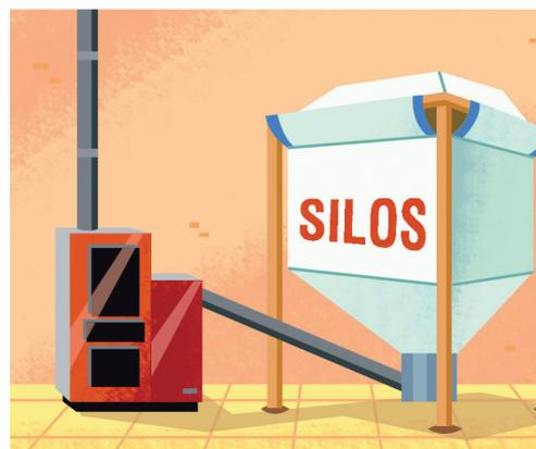
Figura 15 Silo in tessuto con estrazione automatica
