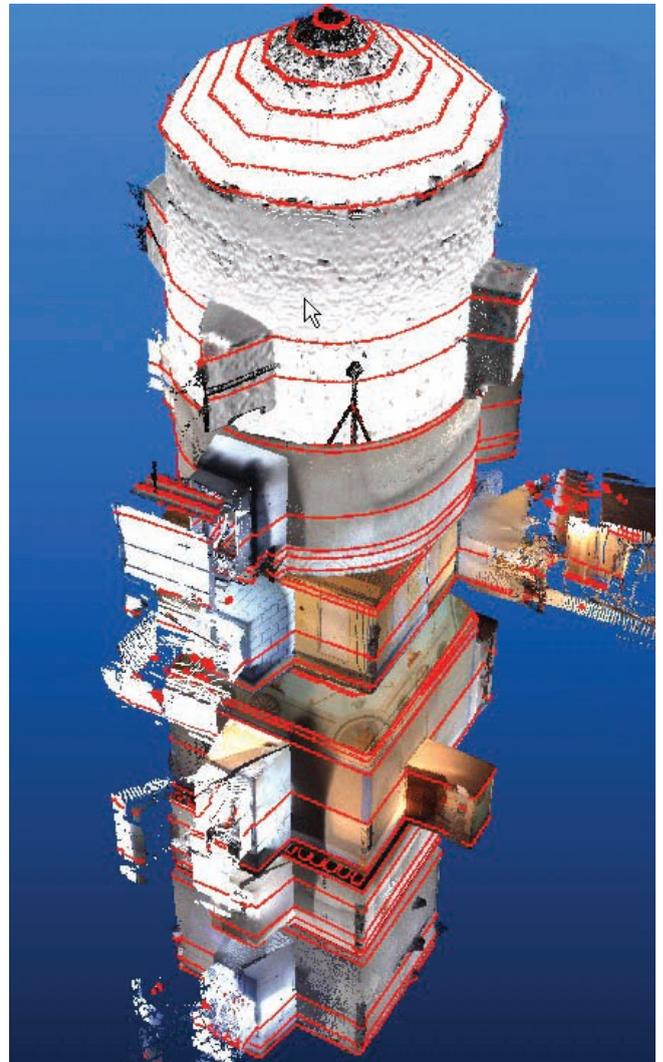
10. Rilievo tridimensionale con tecnologia laser-scan della torre nord-est. (3D Survey, R. Focareta)
