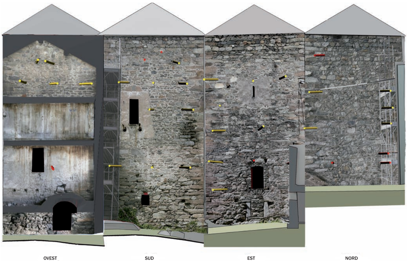
35. Omografie dei quattro lati con inserimento dei travicelli secondo l'angolazione desunta dai rilievi. (Visionetica, elaborazione M. Cortelazzo)
