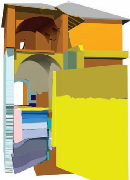
18. Ingresso (amb. 2), spaccato tridimensionale, in gradazioni d'azzurro la stratigrafia dalla quale provengono i materiali. (R. Focareta)
