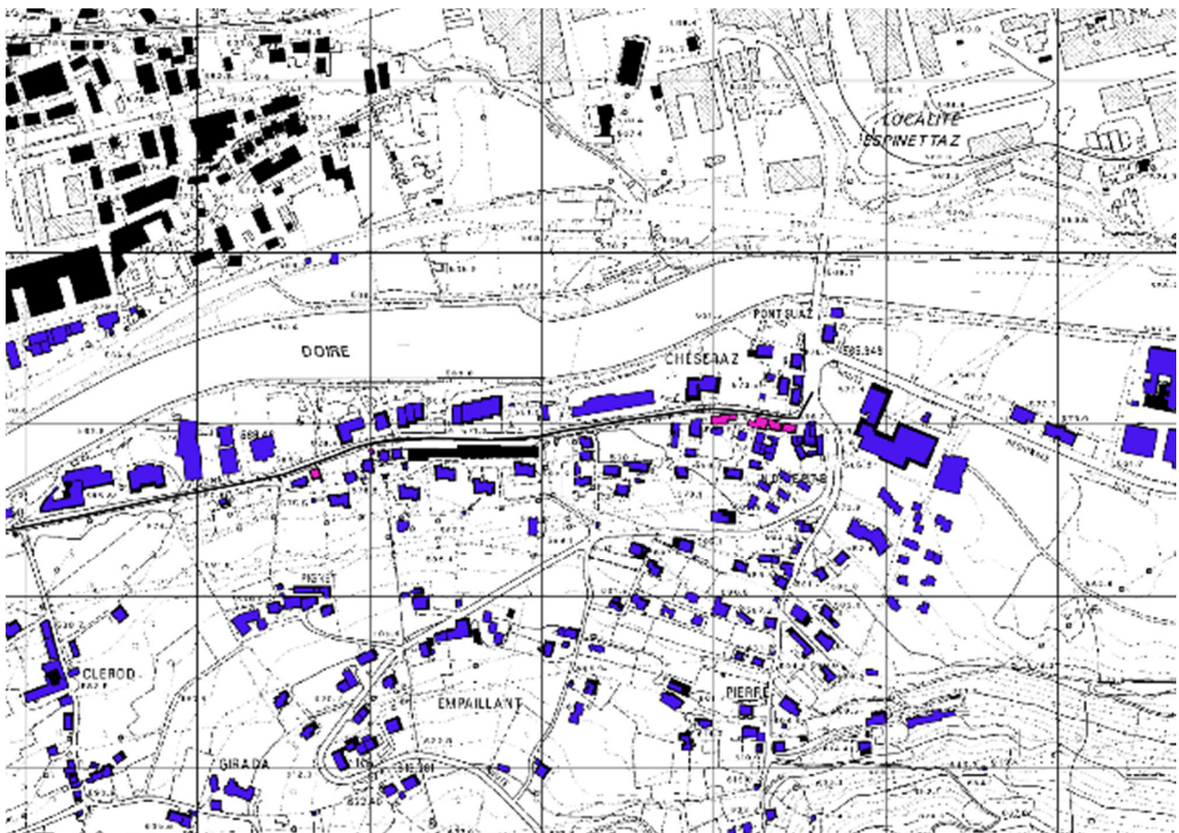
Figura 6 – Edifici con superamento del valore limite di 57 dBA di L night in frazione Pont Suaz (Charvensod)
