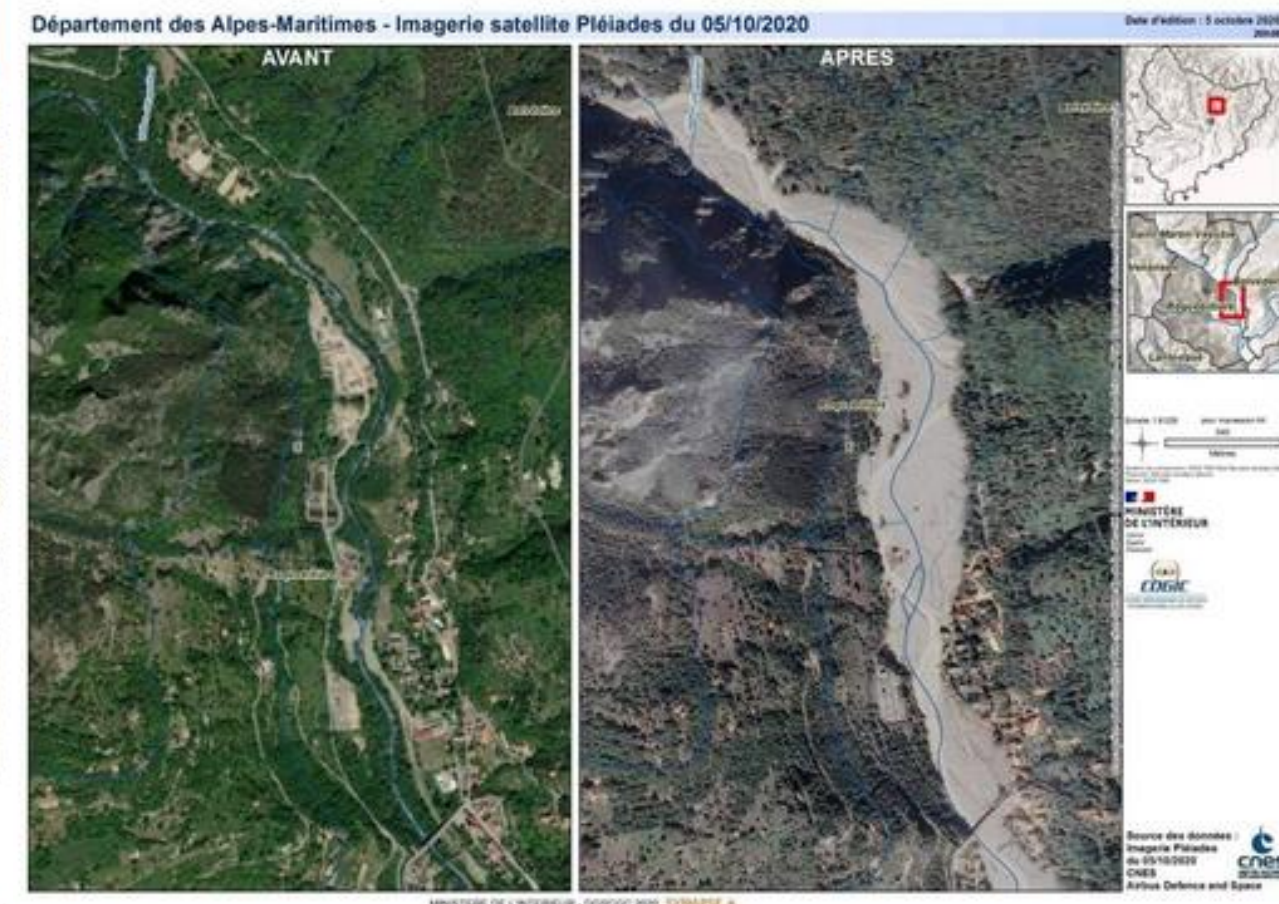
St-Martin-Vésubie (sopra) e Roquebillière (sotto), Alpes Marittimes: confronto tra prima e dopo l'alluvione del 2 ottobre 2020, che evidenzia il notevole ampliamento del letto della Vésubie (clicca sulle immagini per ingrandire). L'evento è stato eccezionale e di portata plurisecolare, ma evidentemente molte delle strutture travolte erano collocate in zone soggette a inondazione seppure con tempi di ritorno lunghi (fonte: Ministero dell'Interno francese, immagini satelliti Pléiades).
